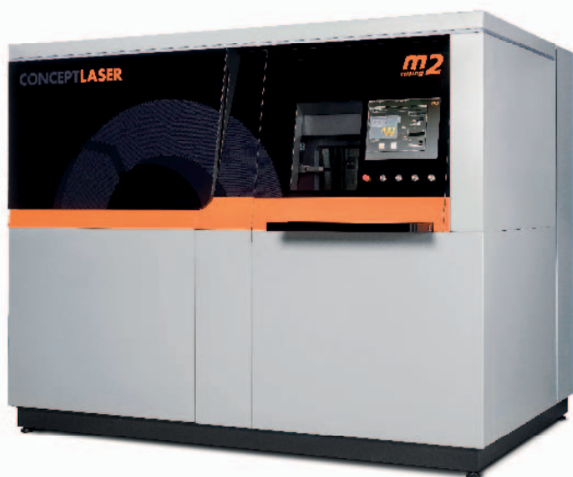
A sinistra: il sistema di fusione laser per polveri metalliche M2 Cusing della Concept Laser, rappresentata in Italia dalla Ridix
