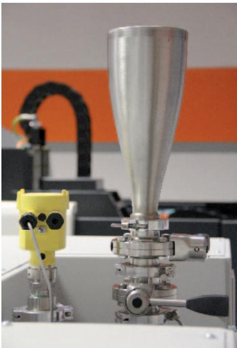
Sistema di gestione delle polveri a tenuta con doppie valvole
