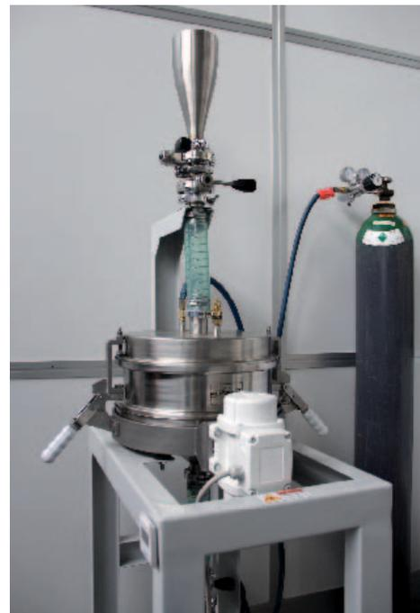
Setacciatore per recupero di oltre il 95% delle polveri in atmosfera protetta di argon
