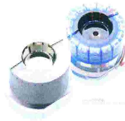
*Inserto di stampo componente attico con canali conformati: riscaldamento (rosso), raffreddamento (blu) e isolamento (bianco). Fonte: Siegfried Hofmann Werkzeugbau GmbH*
