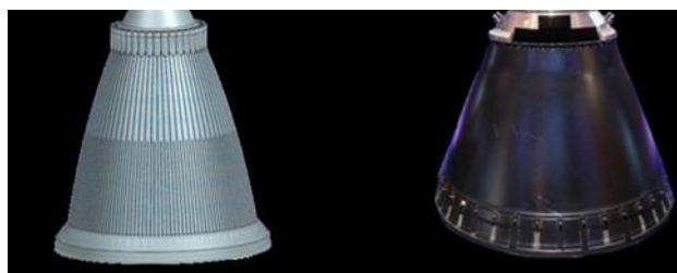
Figura 1: A sinistra il design di un ugello generico, a destra il motore criogenico Ariane 6, stadio superiore
