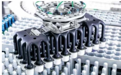
Figura 2: L'uso della fabbricazione additiva ha ridotto la complessità di un gripper a vuoto per confezioni di porzioni di crema di caffè, riducendo il tempo di assemblaggio da un giorno a soli 10 minuti.
