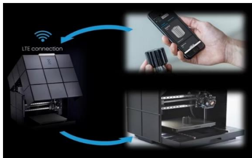
Figura 1: Partbox di Schubert Additive Solutions offre una soluzione per la produzione decentralizzata su richiesta di parti. Il sistema include una piattaforma per lo streaming dei dati di produzione, stampanti 3D e il filamento plastico corrispondente, permettendo ai clienti di acquistare design personalizzati e stampare le parti localmente con qualità affidabile e massima sicurezza.
