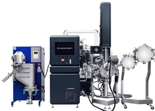
Figura 1: Il rePowder di AMAZEMET è un atomizzatore ultrasonico che può essere utilizzato per produrre polvere metallica da qualsiasi lega e in qualsiasi forma di materia prima, anche in piccole quantità per scopi di ricerca.
