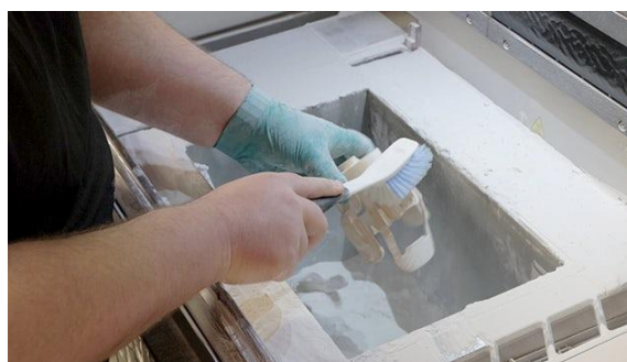
Figura 2: Processo di estrazione del socket dopo stampa 3D con HP Multi Jet Fusion
