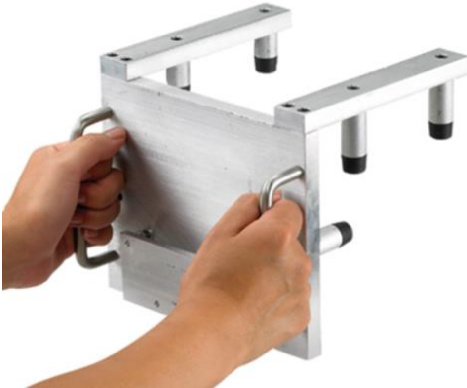
Badge alignment tool prodotto con macchinari CNC in lega di alluminio.
