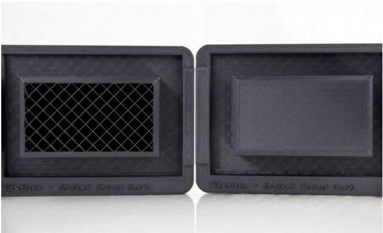
A sinistra è visibile un componente realizzato con la modalità di riempimento sparse, a destra è visibile lo stesso componente realizzato con la modalità solid.
