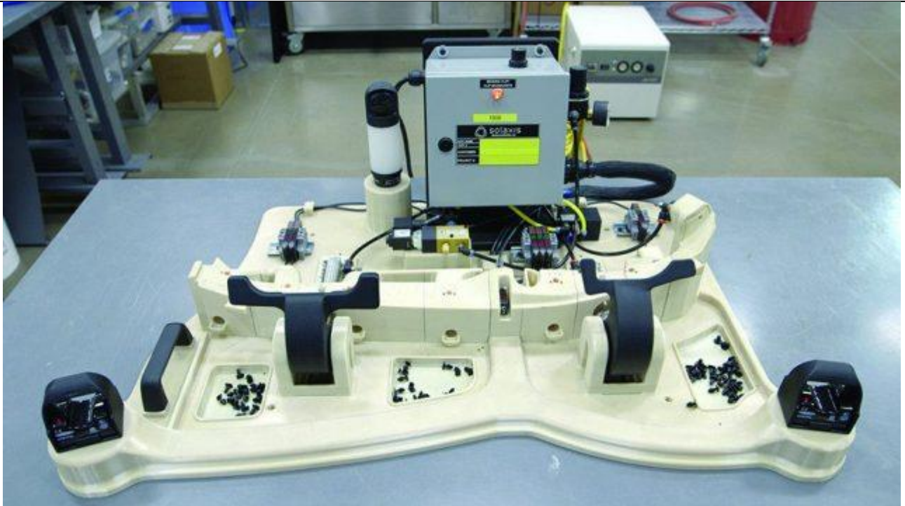
Dima di montaggio realizzata con la tecnologia FDM, con materiale ASA e la modalità di riempimento solid.
