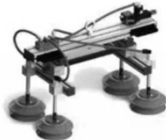
Lo staff tecnico si orienta verso una nuova tipologia di mano di presa, in materiale termoplastico, che presenta delle canalizzazioni integrate, per la gestione dell'aria, a tenuta stagna. La produzione del nuovo componente è resa possibile dal know how tecnico legato all'impiego della tecnologia [Multi Jet Fusion](#) e del materiale [PA 12](#), selezionati per questa specifica applicazione.
