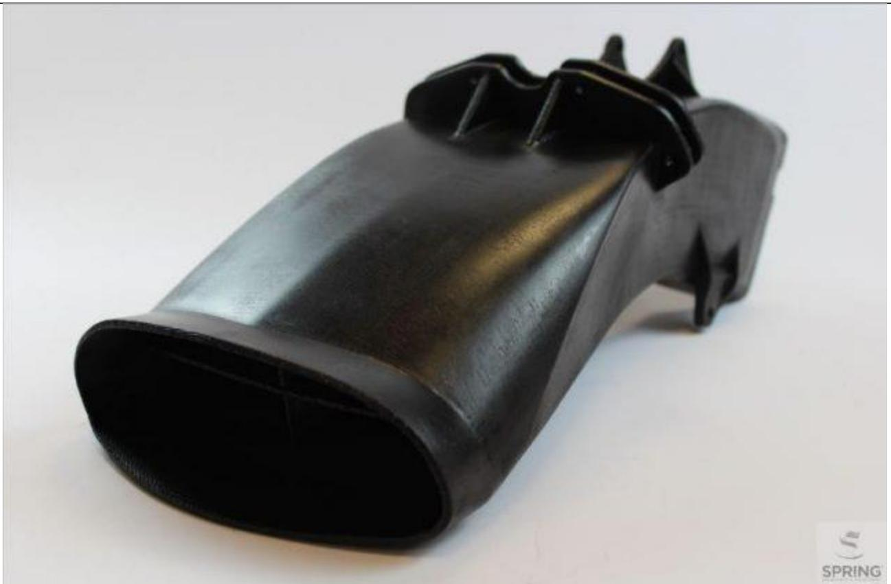
La produzione di **mandrini solubili** consente la realizzazione di manufatti in carbonio. Queste “anime sacrificali”, realizzate impiegando il materiale ST130, vengono ricoperte da pelli di carbonio e sottoposte al trattamento in autoclave. Al termine del ciclo produttivo i mandrini sono sciolti in una soluzione acquosa.
