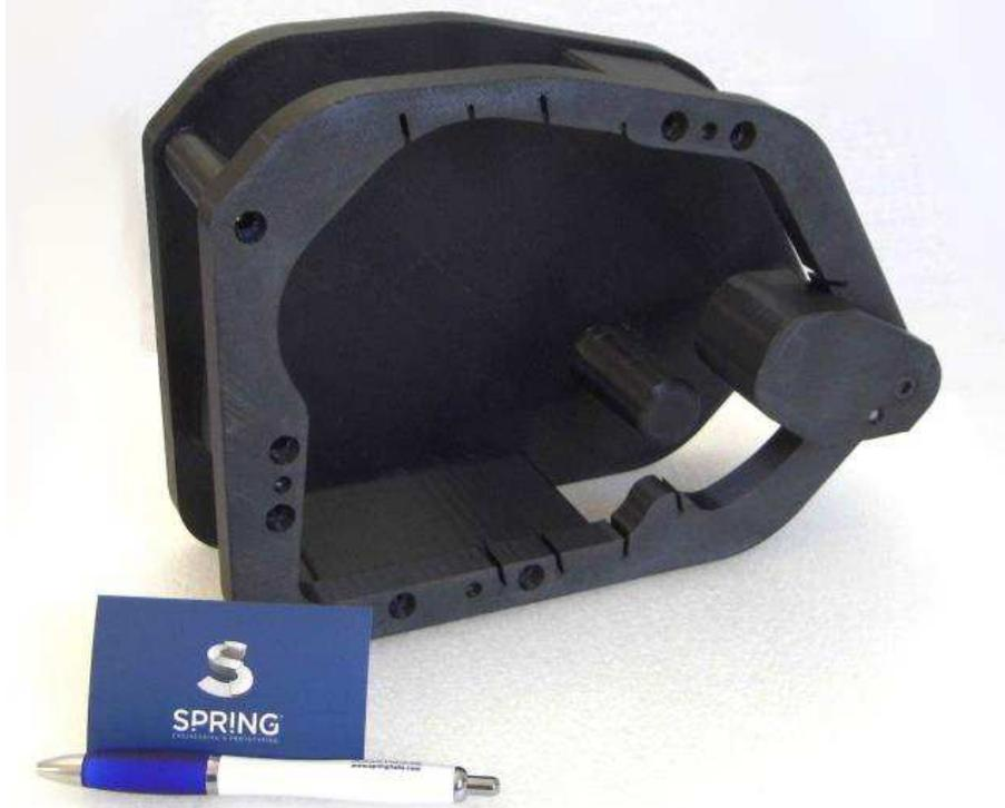
*Attrezzatura di produzione, per l'assemblaggio di componenti meccanici, stampata con tecnologia FDM.*
