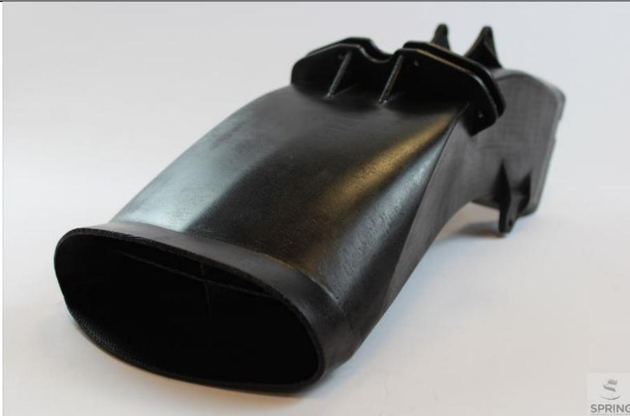
*Convogliatore carena telaio airbox realizzato in additive manufacturing*
