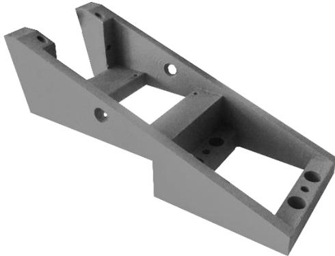
Componente Originale realizzato in lega di alluminio mediante fresatura dal pieno
